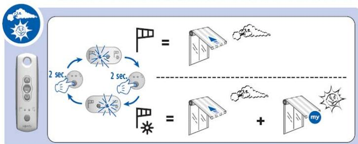
Радиопередатчик Telis Soliris имеет встроенную функцию отключения солнечной автоматики (Sunis Sensor RTS, Soliris Sensor RTS).
