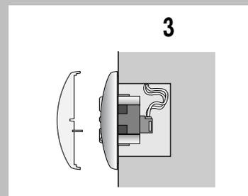
1. Подсоединить выводы к клеммам несущей рамки (расположение клемм см. 2.2) и укрепить несущую рамку в розетку скрытой проводки.
