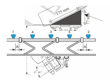
При установке под наклонную поверхность кровли (несущая стропила) можно использовать специальный установочный клин (размеры клина см. на рис.).
