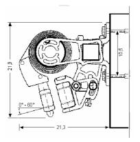
4. Разметка мест креплений. Размер А нужно выдержать в пределах от 100 до 300 мм.
