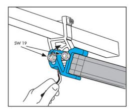
Другой человек должен отпустить 2 болта, а затем 5мм шестигранным ключом установить требуемый наклон тента. После чего нужно плотно затянуть болты.
