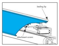
Позаботьтесь о том, чтобы влага не прникала в щель между кожухом и поверхностью стены. Используйте клейкую ленту или герметик.
