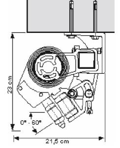
Монтаж также можно производить с использованием универсального кронштейна. Он позволяет производить установку как на стену, так и на потолок. Возможность комплектации таким кронштейном нужно уточнять при заказе маркизы.
