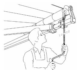
10. Регулировка угла наклона тента.
